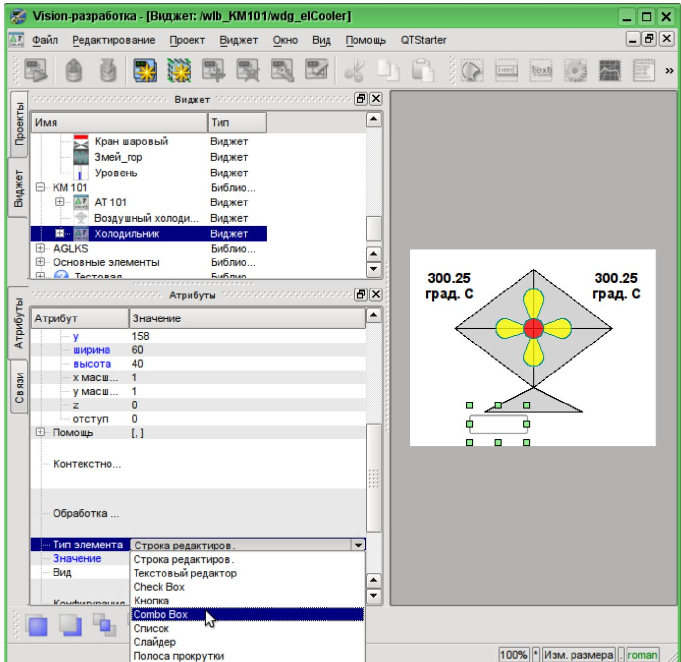
Рис. 5.3.2.13. Изменение "Геометрии" и "Типа элемента" для вновь созданного виджета.
