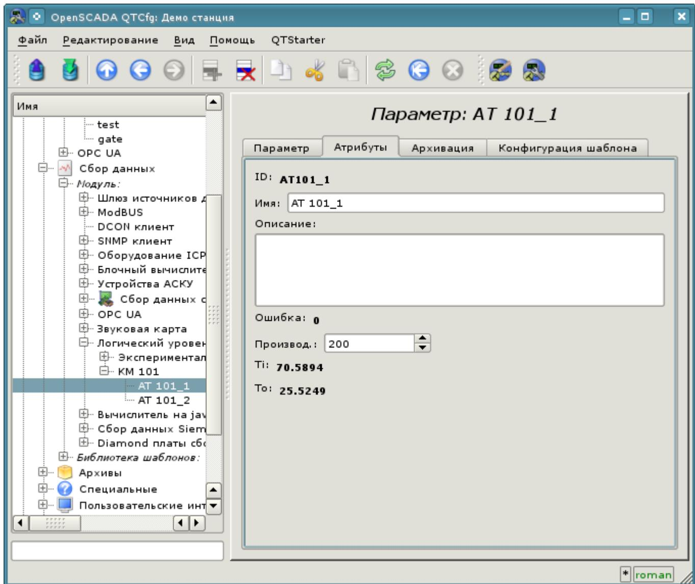
Рис. 4.2.8. Страница атрибутов параметра AT101\_1 модуля "LogicLev".
