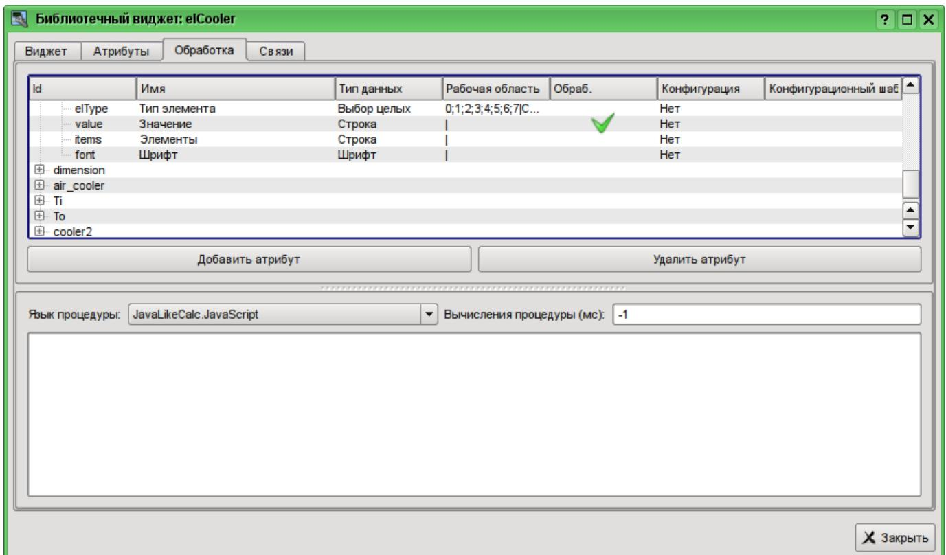
Рис. 5.3.2.17. Включение в обработку атрибута "value" комбобокса "cw".
