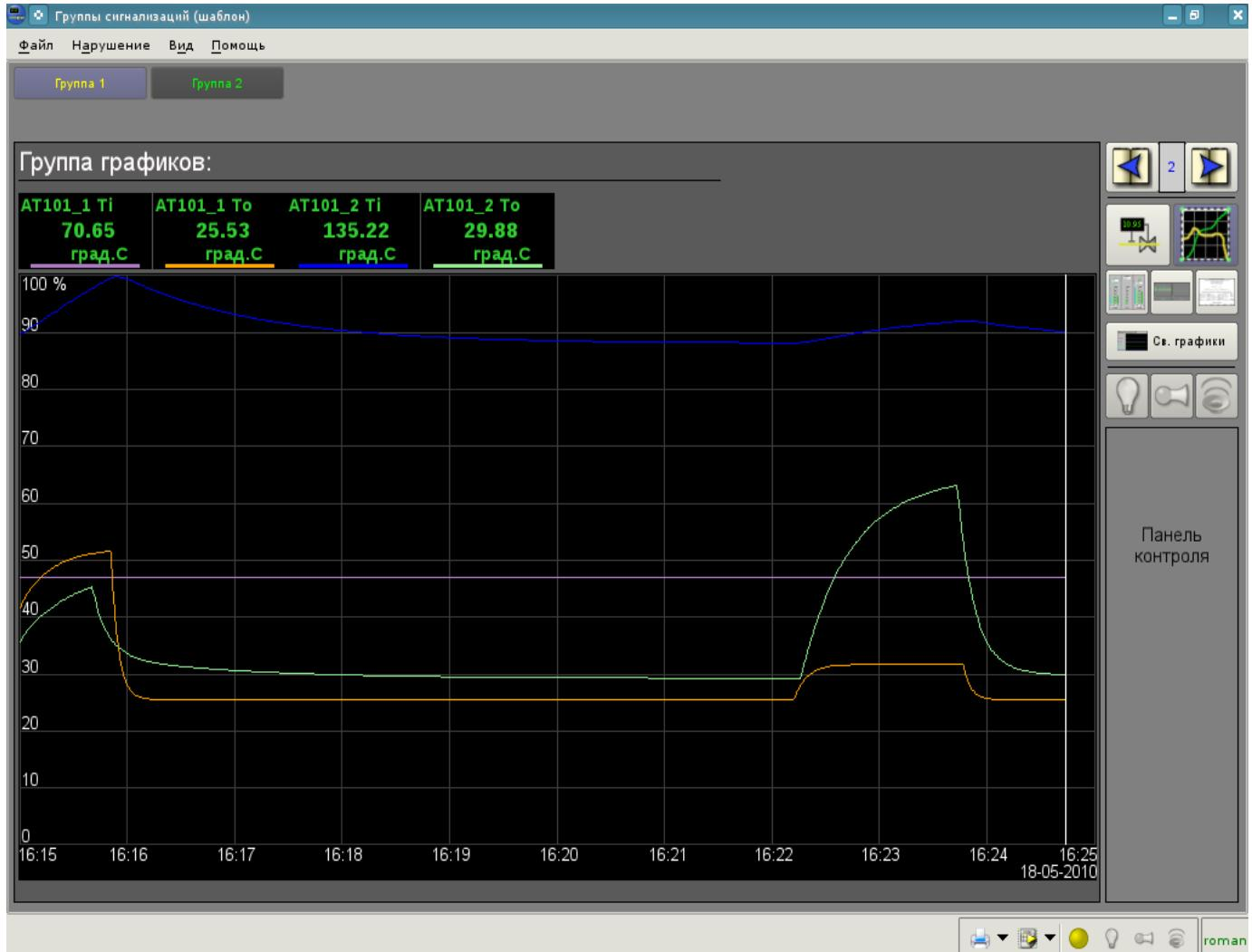
Рис. 5.1.6. Созданная группа графиков с четырьмя подключенными сигналами.
