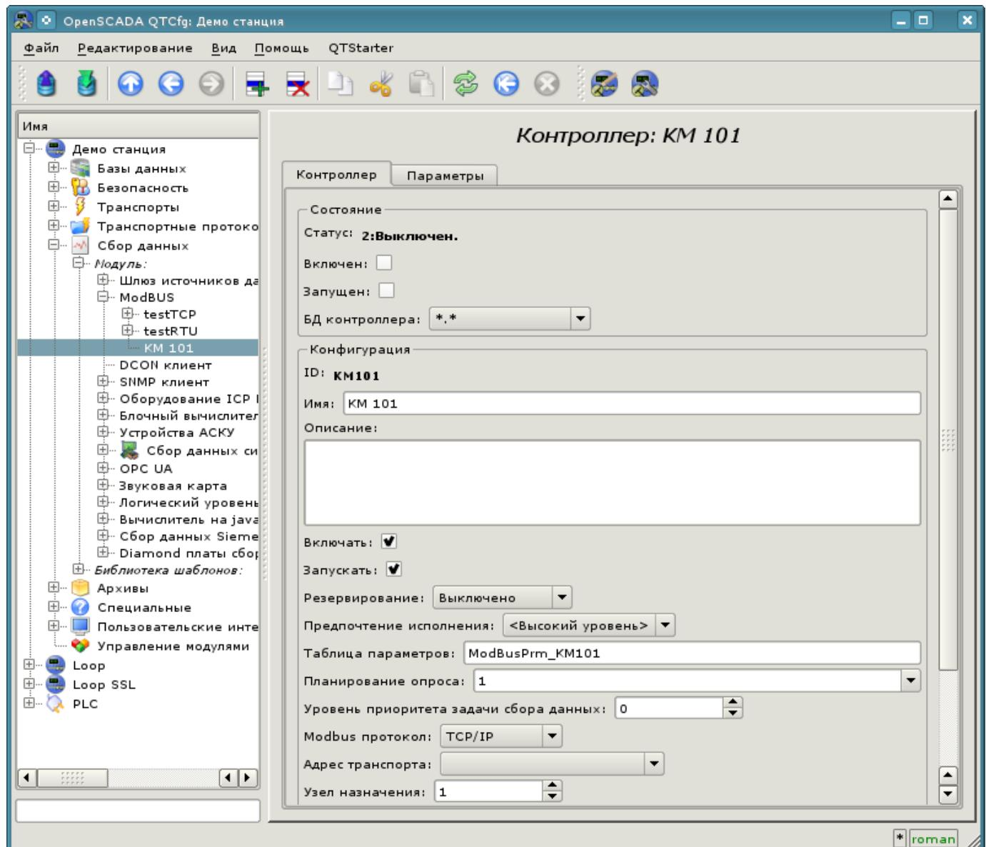
Рис. 4.1.3. Главная вкладка настройки объекта контроллера модуля ModBUS.
