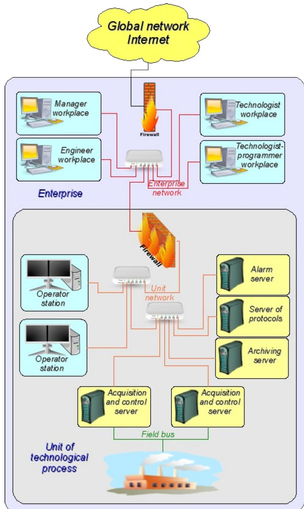
Fig. 2. SCADA-system.
