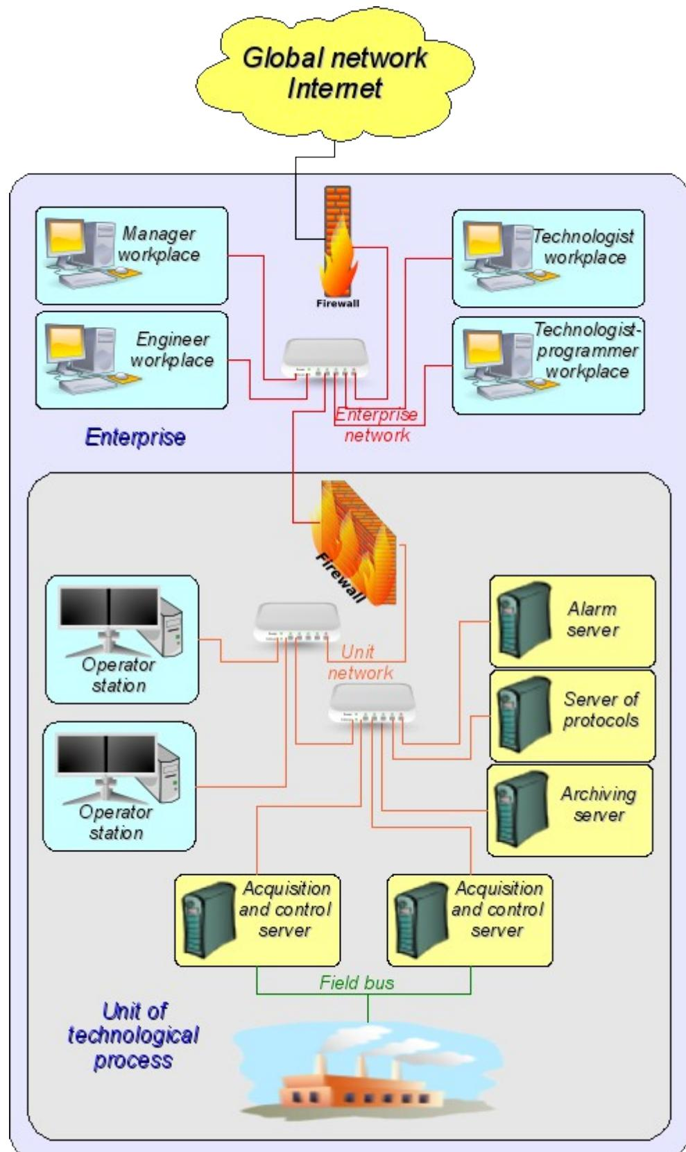
Fig. 2. SCADA-system.
