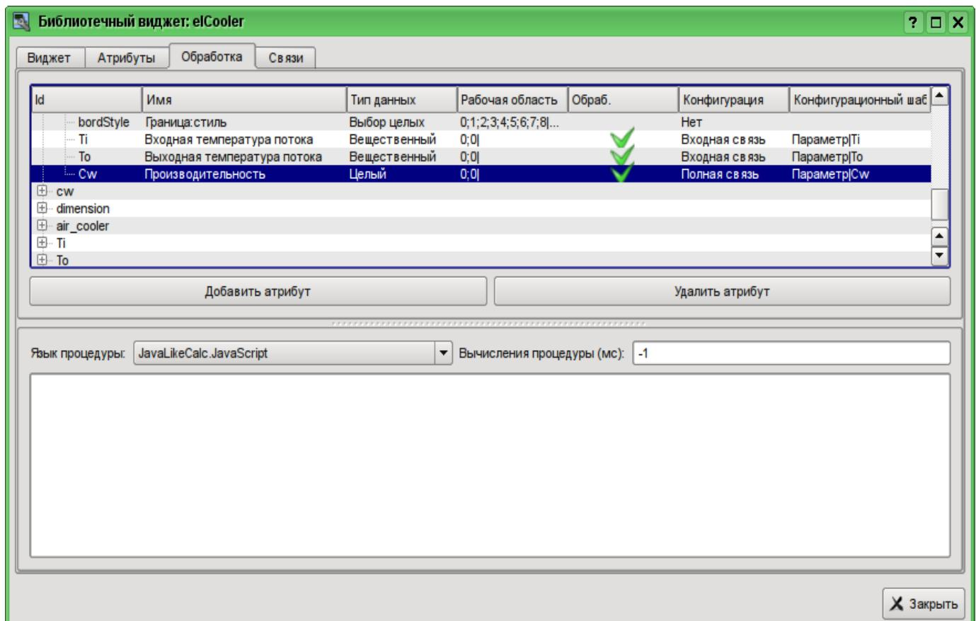
Рис. 5.3.2.16. Добавление трех атрибутов для элемента "elCooler" библиотеки "КМ 101".
