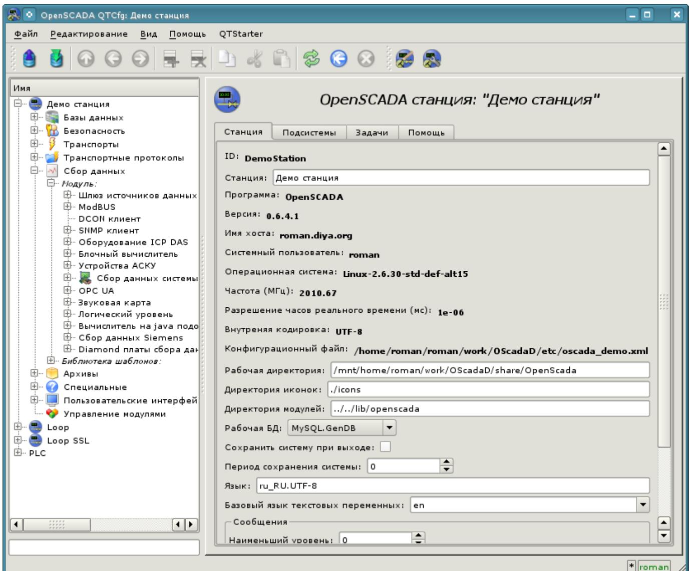
Рис. 3.2. OpenSCADA конфигуратор - QTCfg, корневая страница.
