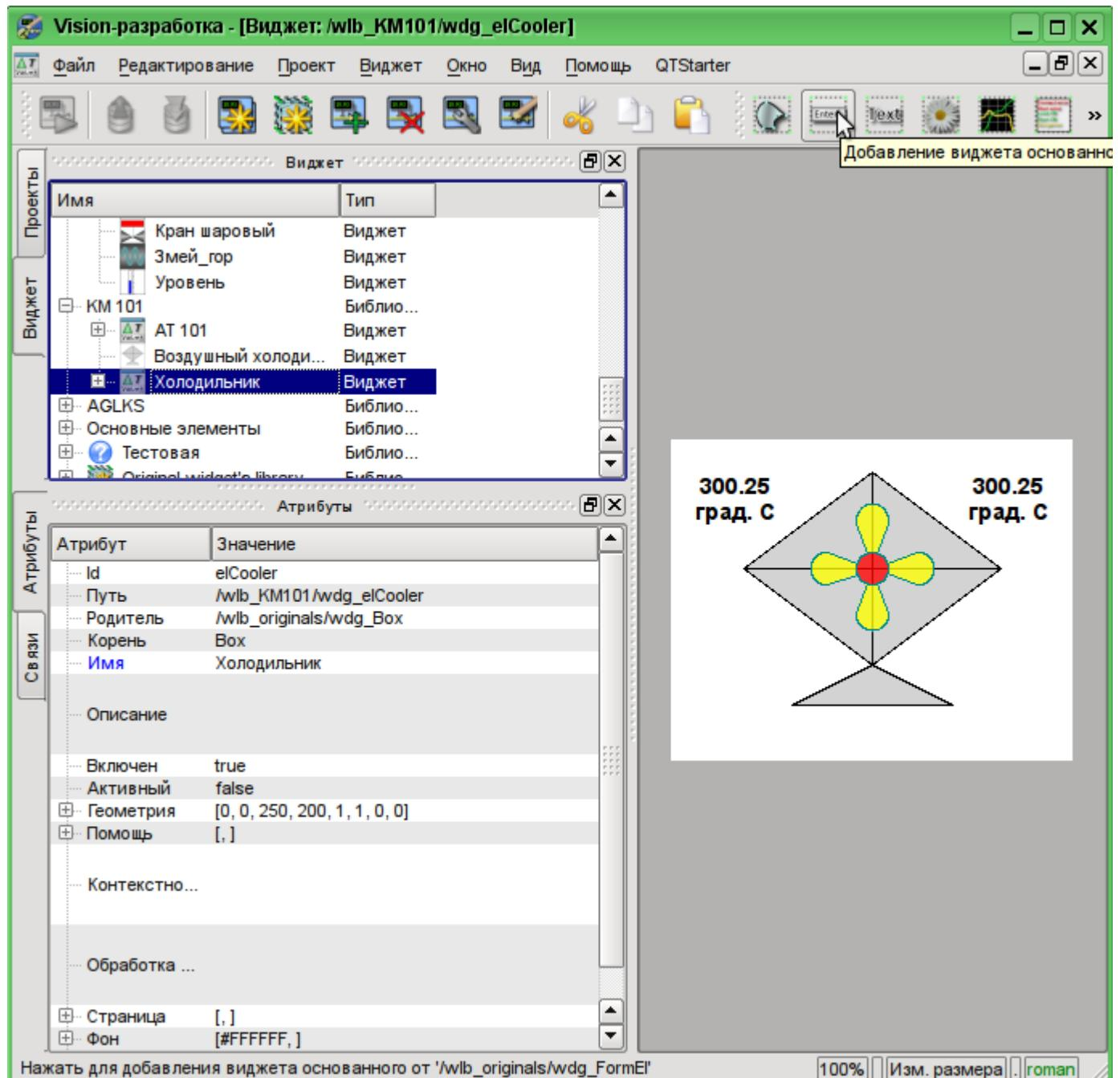
Рис. 5.3.2.13. Добавление виджета, основанного на примитиве "Элементы формы".
