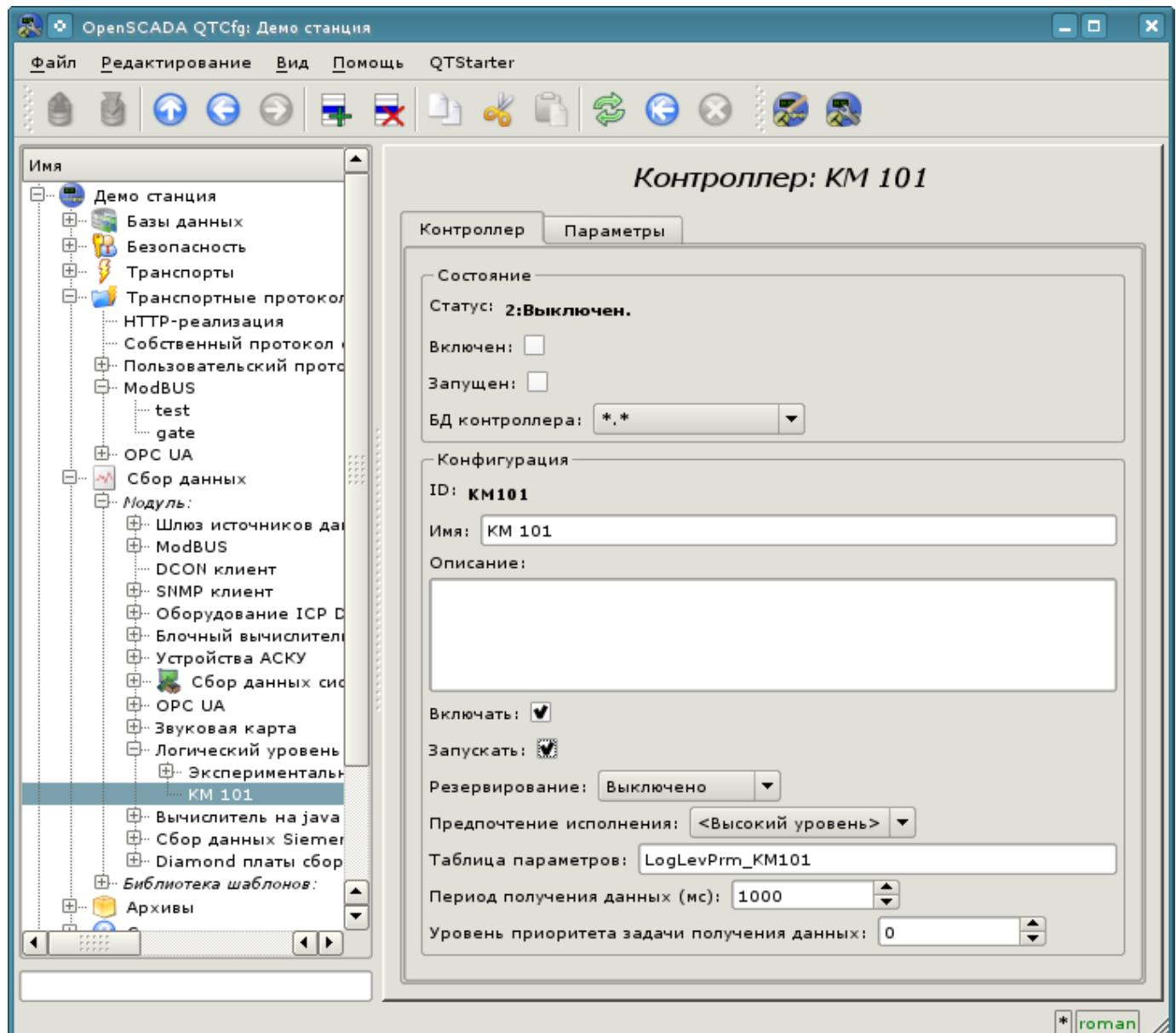
Рис. 4.2.3. Главная вкладка настройки объекта контроллера модуля LogicLev.
