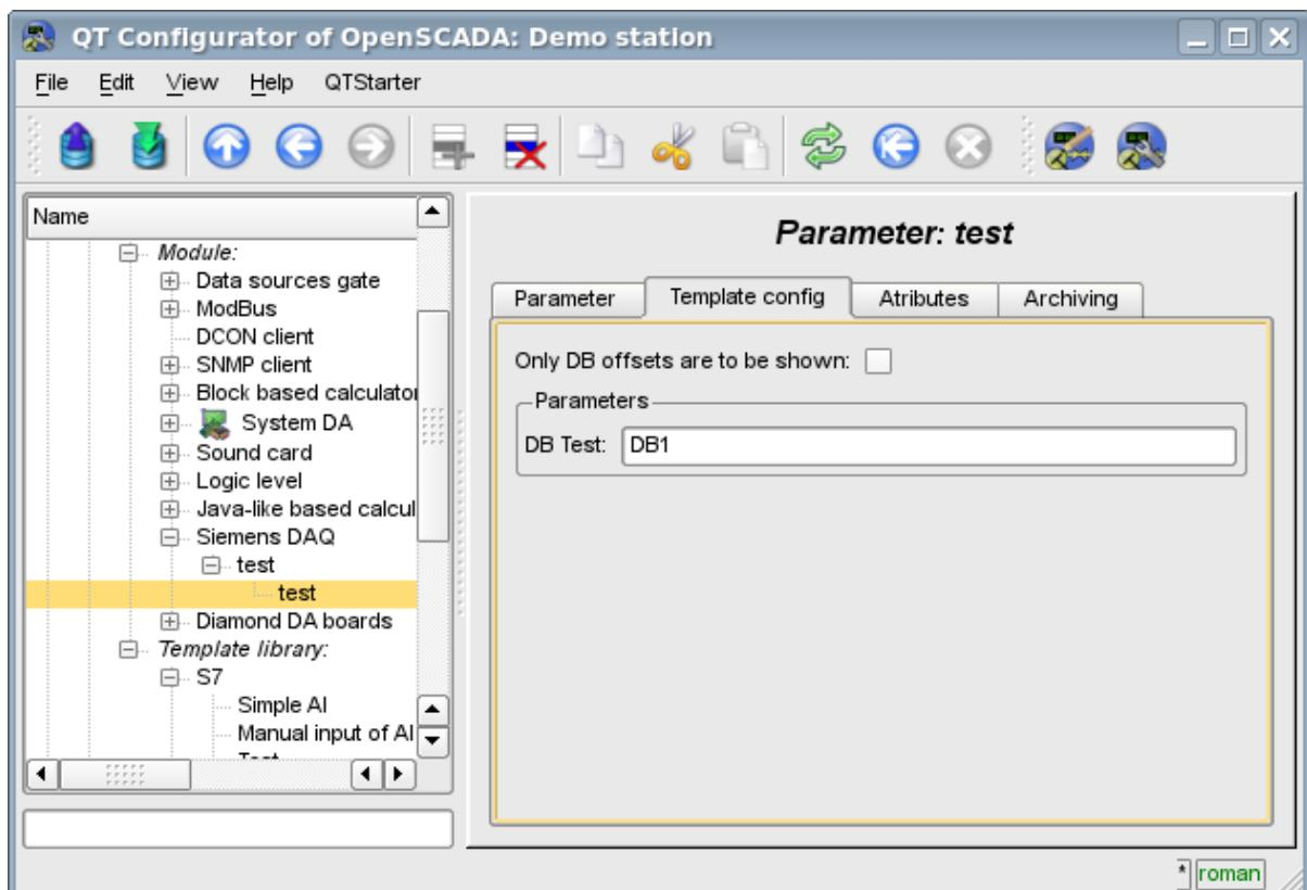
Fig.6. Configuration tab of the template of parameter
