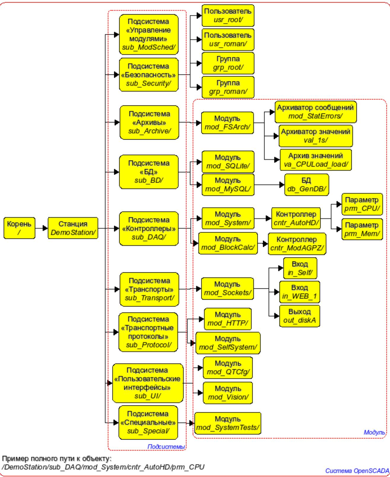
Рис. 8. Пример динамического дерева узлов системы OpenSCADA.
