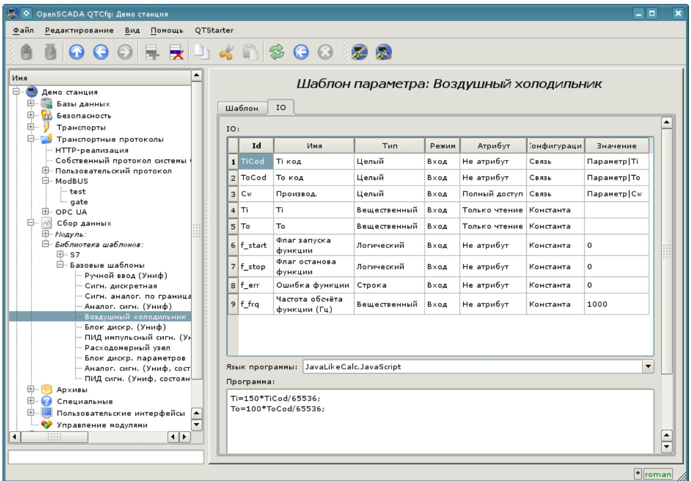
Рис. 4.2.2. Вкладка "IO" страницы конфигурации объекта шаблона.
